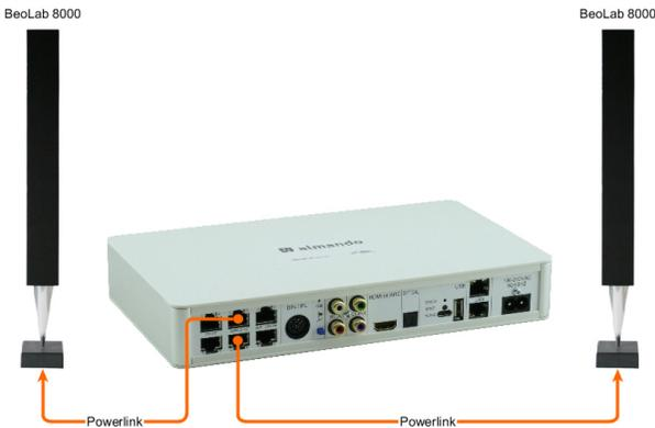
Für ältere B&O Lautsprecher (z.B. BeoLab 5, BeoLab 8000, BeoLab 6000 etc.) benötigen Sie zum Anschluss spezielle Adapter RJ45 <-> Powerlink.
