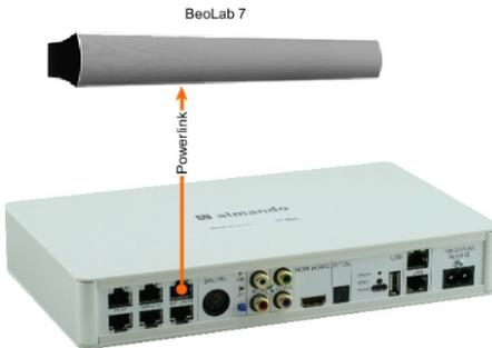
Die rechte obere RJ45 Buchse ist speziell nur für den Anschluss von Center-Lautsprechern konzipiert. Der Center-Ton wird hier an beiden Powerlink Audio-Signalen der Buchse ausgegeben. Damit ist der Anschluss sowohl von Mono- wie auch von Stereo-Lautsprechern (wie hier dargestellt mit einem BeoLab 7) möglich.
