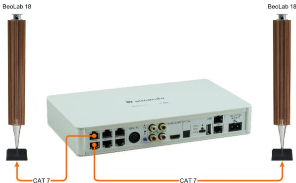
Neuere B&O Lautsprecher (z.B. BeoLab 18) schließen Sie direkt mit einem CAT 7 Patchkabel an.
